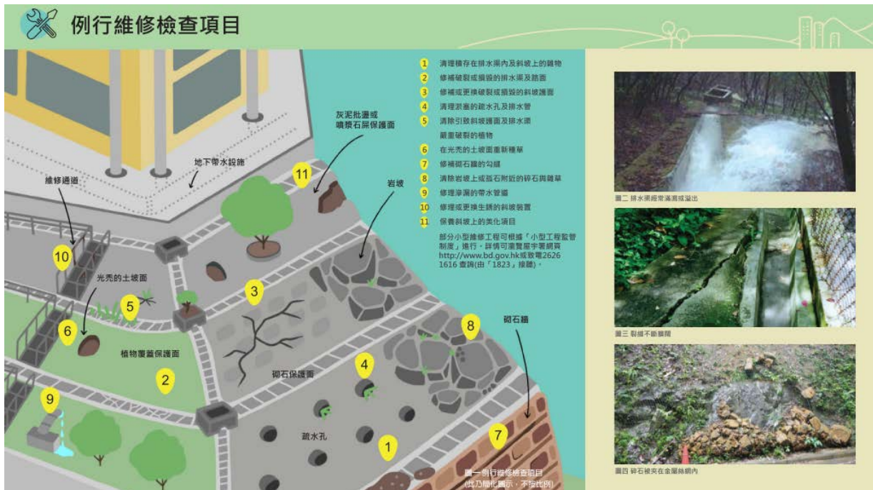
图 6: 一般斜坡维修工程 (取自土拓署网站)
