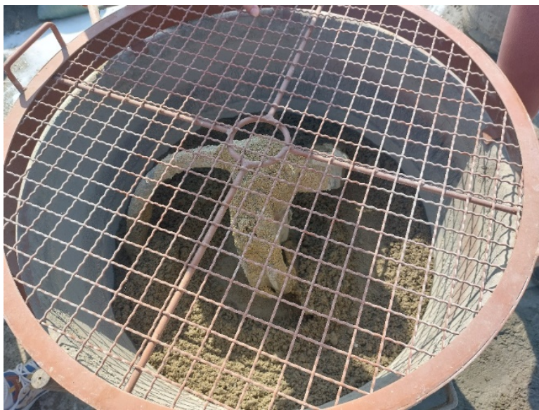
圖 4：電動攪拌機的安全罩 (由公署人員於 2024 年 1 月拍攝)
