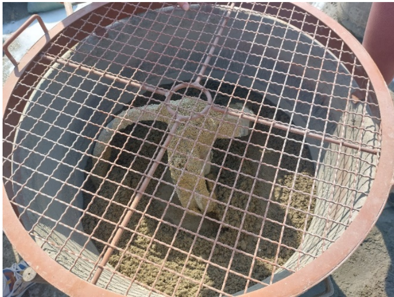
图 4：电动搅拌机的安全罩 (由公署人员于 2024 年 1 月拍摄)
